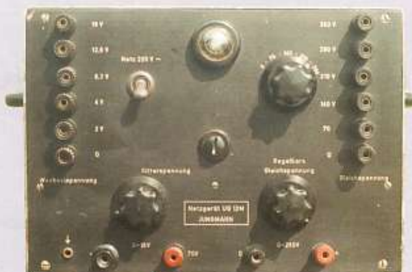
Gloeispanning en regelbare hoogspanning voor o.a. buizenexperimenten
